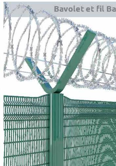
Le bavolet en acier, simple ou double, en acier se glisse dans le poteau et se fixe avec des vis. Le fil barbelé (la ronce ou le concertina) est bloqué sur les bavolets ce qui permet de sécuriser votre site. Pour une clôture de protection optimale, des lisses dentées peuvent être ajoutés sur les panneaux.
